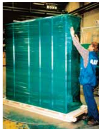
El-skab emballeret med ZERUST® Valeno strækfilm.
