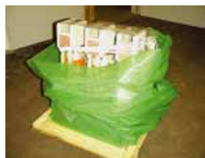
Transformator som beskyttes med ZERUST® Valeno pose.
